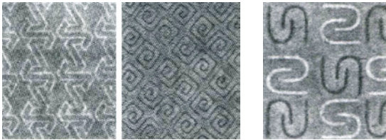
Рис.1.6. Двухтоновые (слева) и трехтоновый водяной знак
