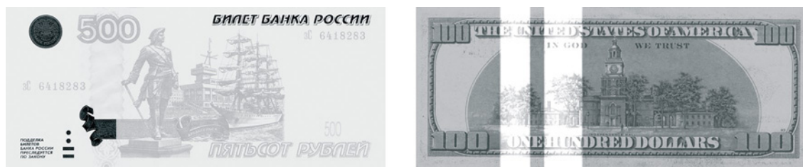
Рис.1.37. Элементы ИК-защиты на банкнотах
