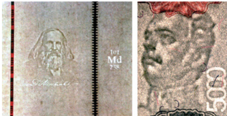
Рис.1.7. Образец банкнотной бумаги “Менделеев” и водяные знаки в банкноте 5000 рублей (на просвет)
