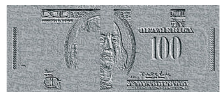
Рис.1.36. Распределение красок с ферромагнитной компонентой на банкноте 100 долларов США
